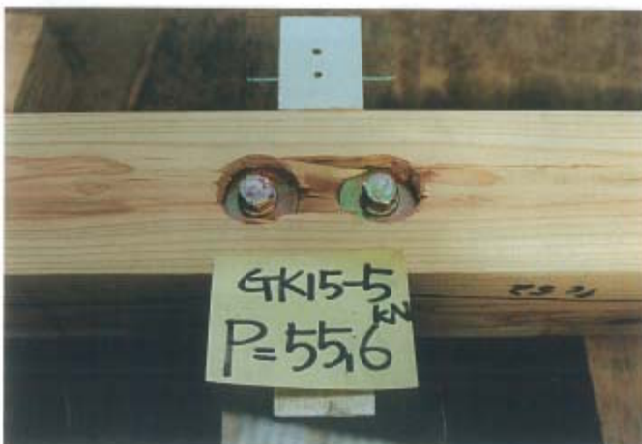
写真-3 破壊状況
