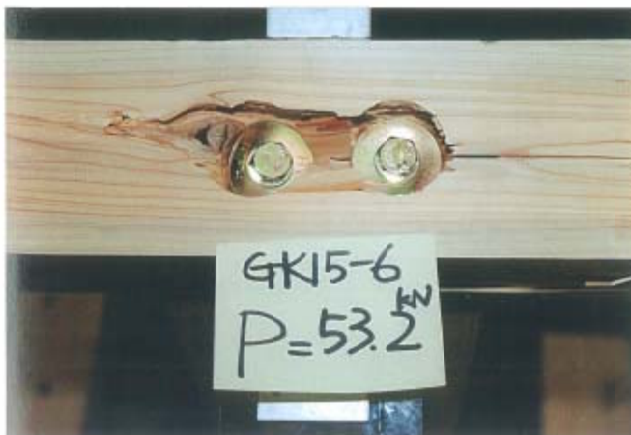
写真-6 破壊状況
