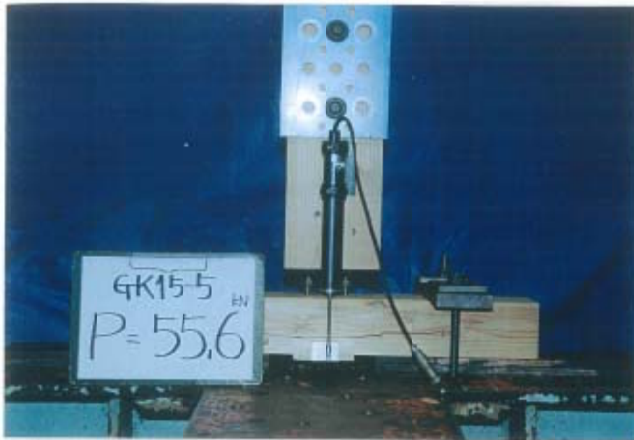
写真-1 破壊状況
