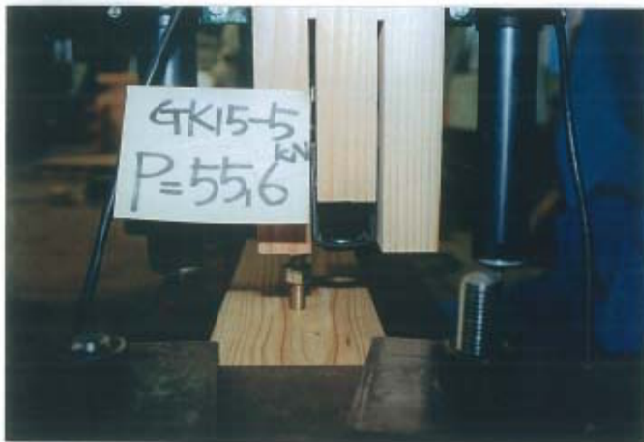
写真-2 破壊状況
