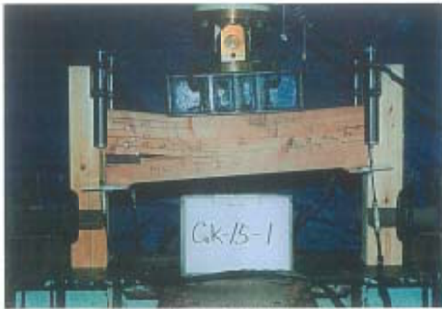
写真-1 破壊状況
