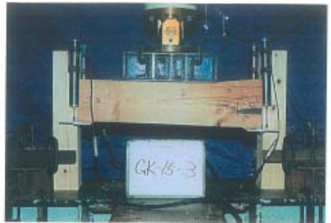
写真-2 破壊状況
