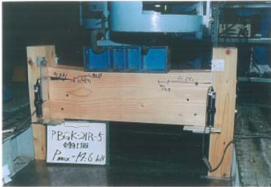
写真-3 破壊状況
