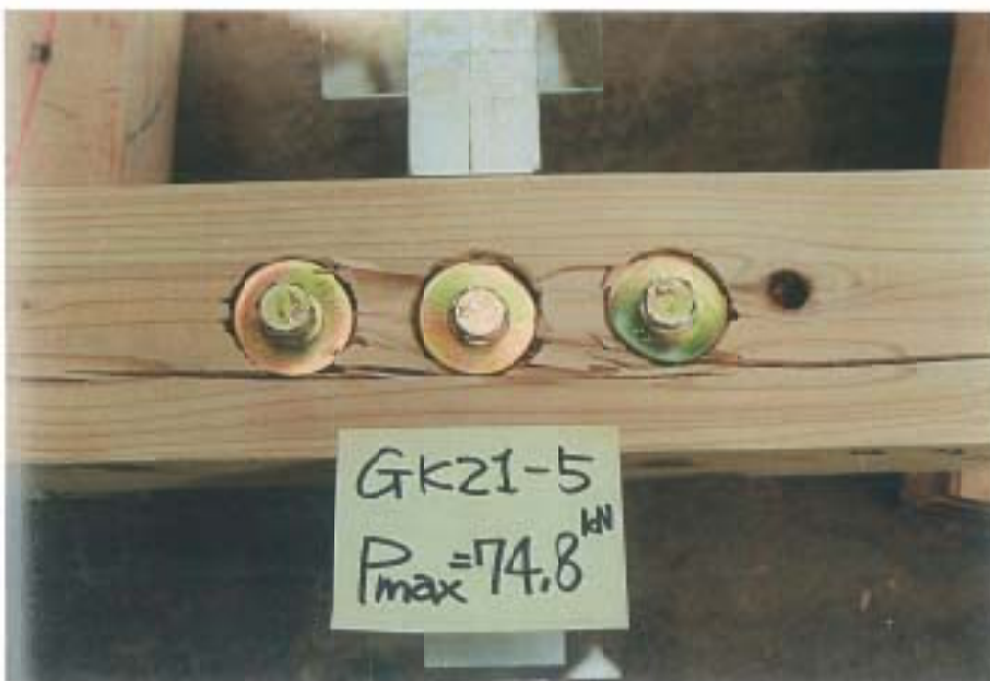
写真-6 破壊状況
