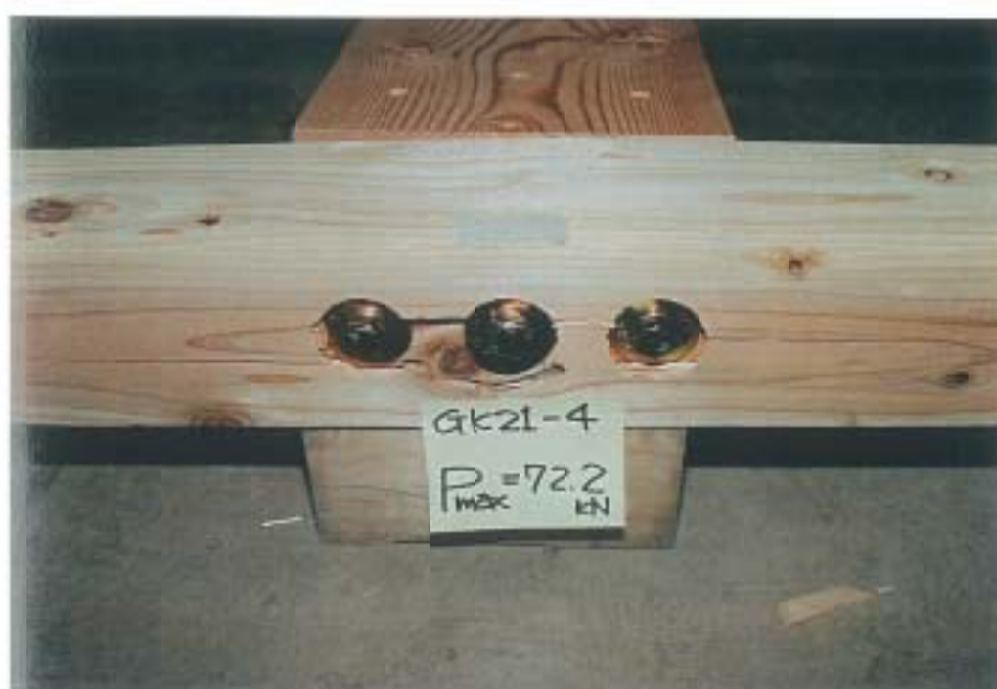
写真-3 破壊状況
