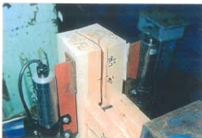
写真-4 破壊状況
