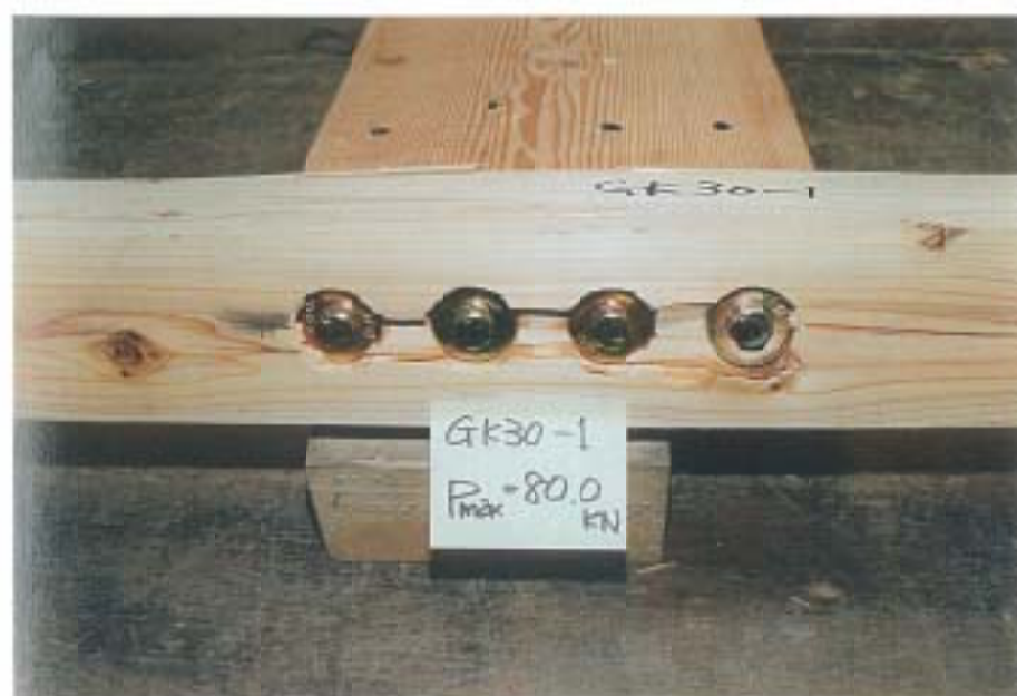
写真-3 破壊状況
