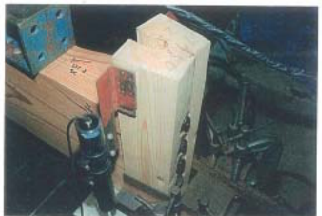
写真-6 破壊状況
