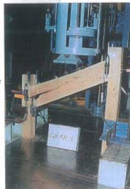
写真-6 破断状況
