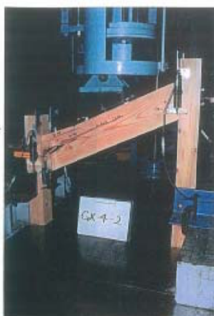
写真-2 破断状況
