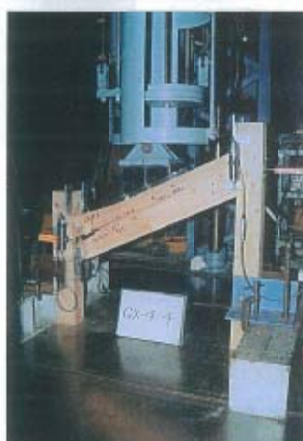
写真-4 破断状況
