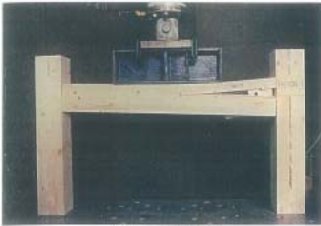
写真-1 破壊状況 試験体記号: THE-10R-1 最大荷重: 9.2kN
