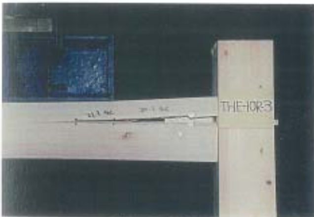
写真-3 破壊状況 試験体記号: THE-10R-3 最大荷重: 10.9kN
