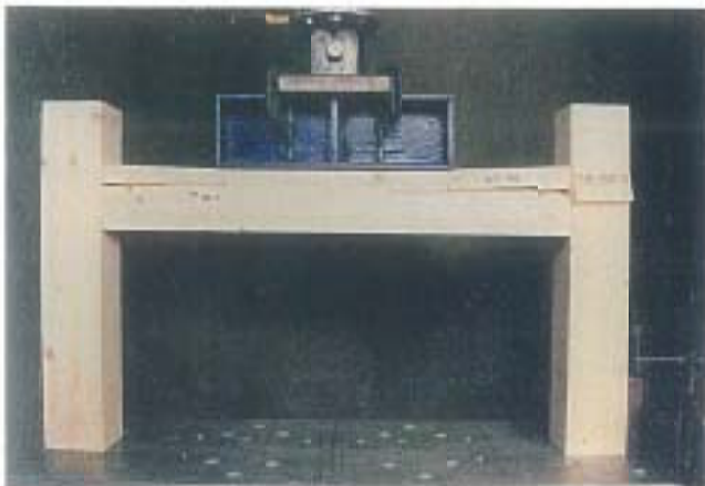
写真-5 破壊状況 試験体記号: THE-10R-5 最大荷重: 10.3kN
