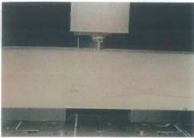
写真-1 破壊状況 試験体記号: THE-10T-1 最大荷重: 33.1kN
