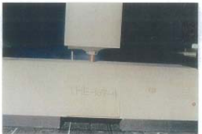
写真-4 破壊状況 試験体記号: THE-10T-4 最大荷重: 32.9kN
