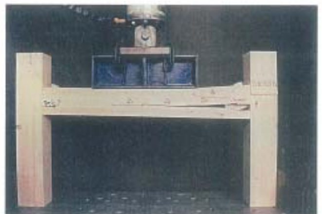
写真-6 破壊状況
