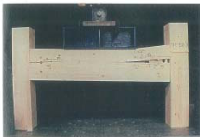
写真-3 破壊状況 試験体記号: THE-15R-3 破壊荷重: 38.1kN 30mm 以内の最大荷重: 35.0kN
