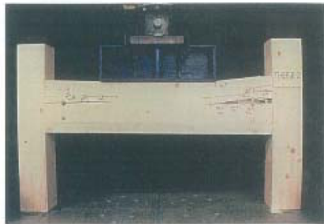
写真-2 破壊状況 試験体記号: THE-15R-2 破壊荷重: 39.5kN 30mm 以内の最大荷重: 38.1kN
