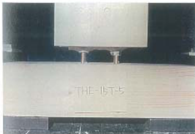
写真-5 破壊状況 試験体記号: THE-15T-5 破壊荷重: 61.8kN 30mm以内の最大荷重: 61.6kN
