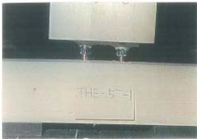
写真-1 破壊状況 試験体記号: THE-15T-1 最大荷重: 65.4kN
