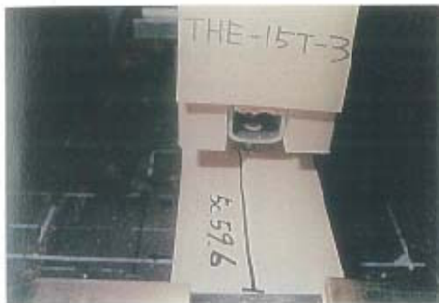
写真-3 破壊状況 試験体記号: THE-15T-3 破壊荷重: 61.7kN 30mm以内の最大荷重: 61.6kN
