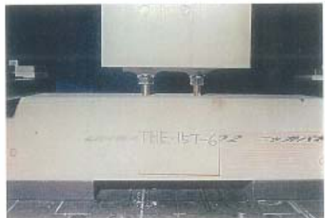
写真-6 破壊状況 試験体記号: THE-15T-6 破壊荷重: 64.2kN 30mm以内の最大荷重: 64.1kN
