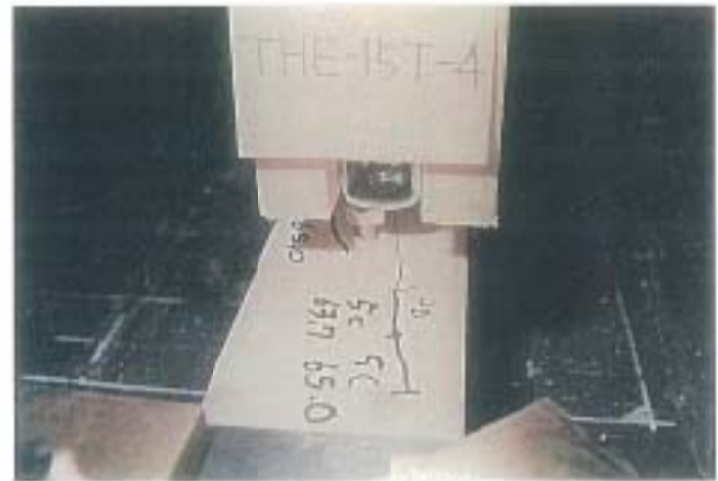
写真-4 破壊状況 試験体記号: THE-15T-4 最大荷重: 65.0kN
