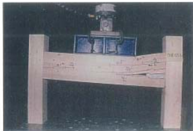
写真-6 破壊状況
