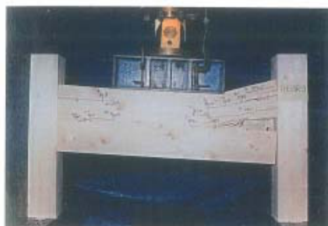
写真-3 破壊状況 試験体記号: THE-21R-3 最大荷重: 45.7kN
