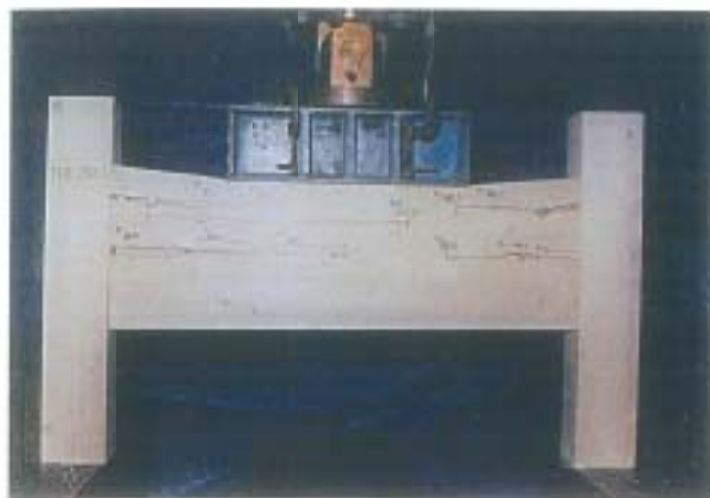
写真-1 破壊状況 試験体記号: THE-21R-1 破壊荷重: 54.9kN 30mm以内の最大荷重: 54.5kN
