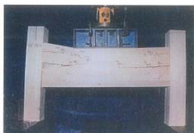
写真-6 破壊状況 試験体記号: THE-21R-6 最大荷重: 49.3kN
