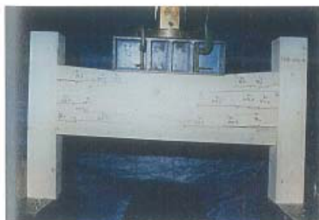
写真-5 破壊状況 試験体記号: THE-215-5 破壊荷重: 62.6kN 30mm 以内の最大荷重: 59.9kN
