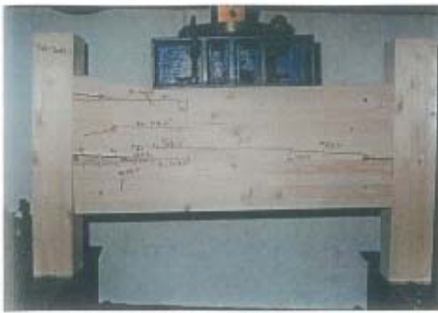
写真-1 破壊状況 試験体記号: THE-30R-1 最大荷重: 64.1kN
