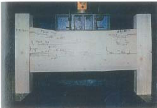
写真-3 破壊状況 試験体記号: THE-30R-3 最大荷重: 69.4kN
