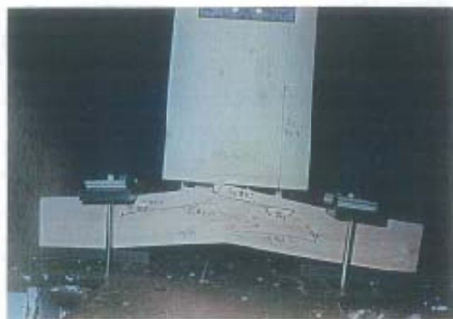
写真-1 破壊状況 試験体記号: THE-30T-1 最大荷重: 90.9kN
