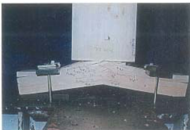
写真-6 破壊状況 試験体記号: THE-30T-6 最大荷重: 71.7kN
