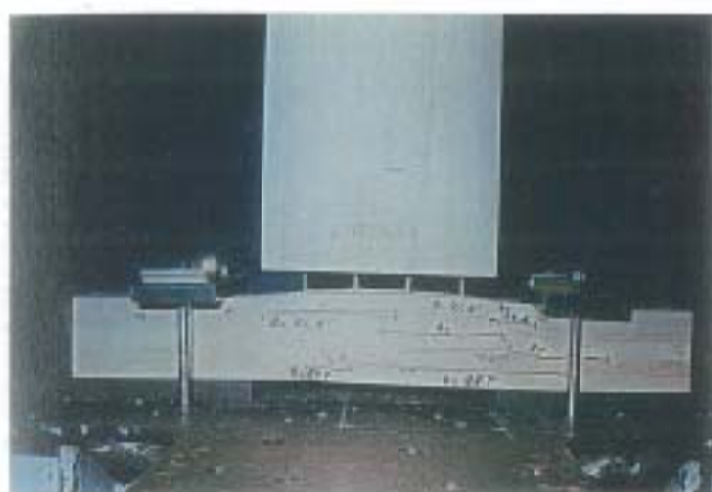
写真-3 破壊状況 試験体記号: THE-30T-3 最大荷重: 101.2kN
