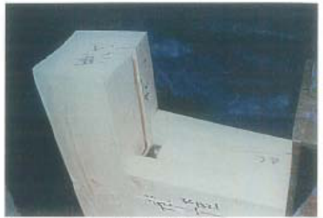
写真-2 破壊状況 試験体記号: THE-30S-2 最大荷重: 81.2kN
