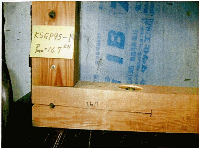
写真-1 破壊状況
