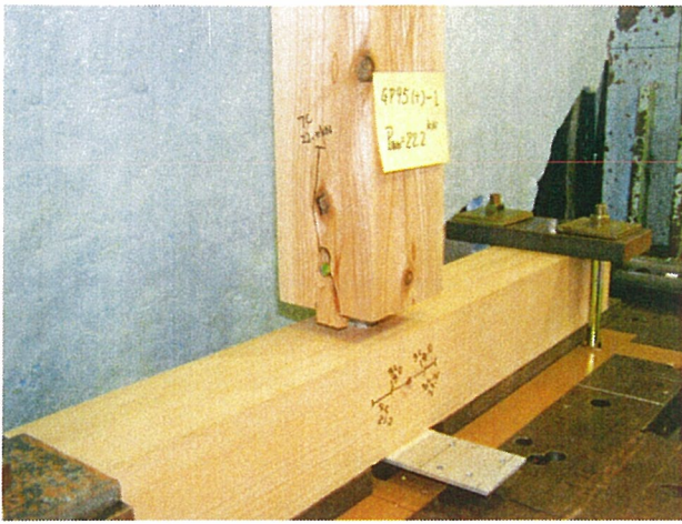
写真-1 破壊状況
