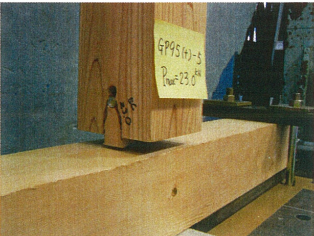
写真-5 破壊状況
