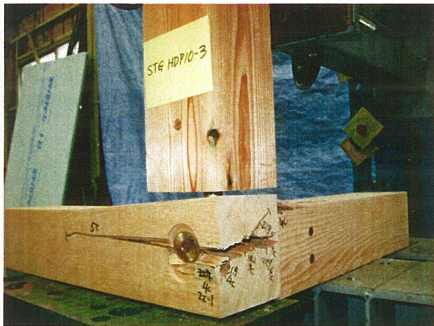
写真-3 破壊状況 試験体記号: STG HDP10-3 最大荷重: 22.1kN ・土台①, ②の割れ
