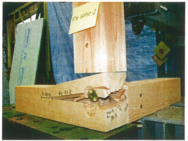
写真-2 破壊状況 試験体記号: STG HDP10-2 破壊荷重: 22.3kN 30mm以内の最大荷重: 21.2kN ・土台①の割れ
