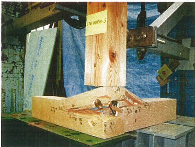
写真-5 破壊状況 試験体記号: STG HDP10-5 破壊荷重: 25.5kN 30mm以内の最大荷重: 21.0kN ・土台①, ②の割れ及び柱のドリフトピン位置での割れ
