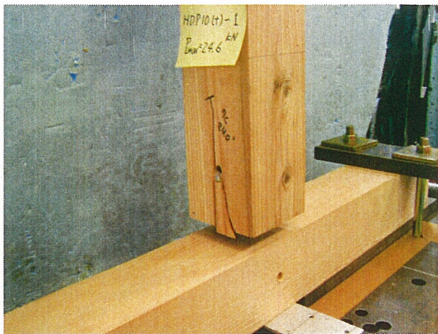
写真-1 破壊状況
