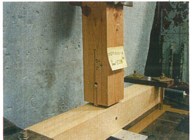
写真-6 破壊状況
