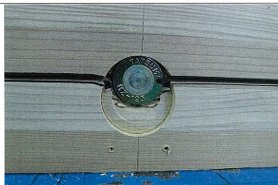
写真 5.4 代表的な破壊性状 (No. 6)
