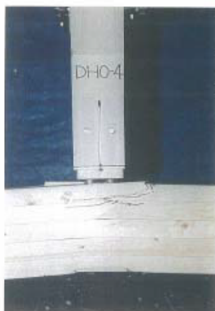
写真-4 破壊状況 試験体記号: DH0-4 最大荷重: 79.9kN 梁の割れ
