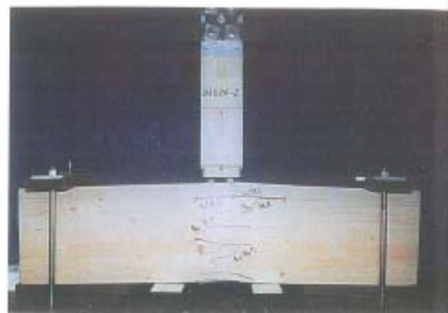
写真-2 破壊状況 試験体記号: DH024-2 最大荷重: 96.7kN
